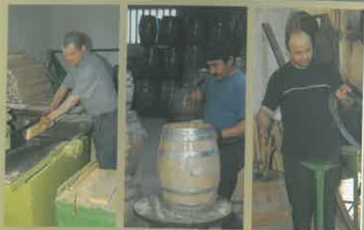
Algumas fases do processo de fabricação do barril, 2009. Tanoaria de Santa Gomes Porto & Filhos Lda, Paramos Imagem: André Galvão
