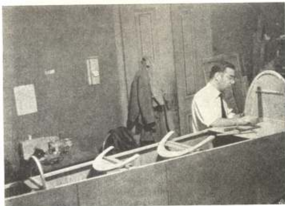
Acertando os arcos que hão de constituir o dorso da fuselagem do Bêbé Jodel
