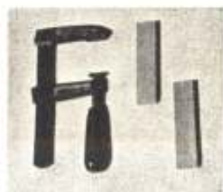
Grampo e barretas para prova de colagem
