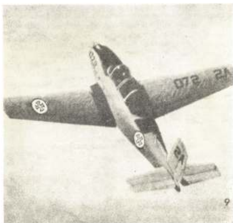
Esta figura mostra claramente as rugas de compressão no estradorso da asa dum avião durante uma manobra com valores «G» positivos altos.
