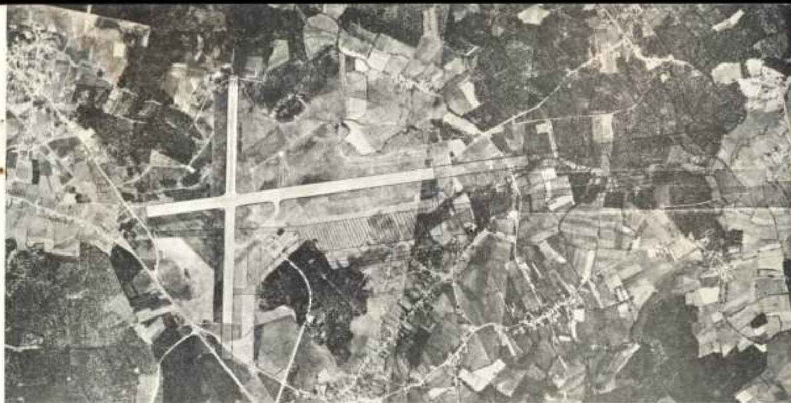
Fotografia do Aeroporto do Porto, vendo-se a branco as primitivas pistas, a cinzento as pistas actuais e a tracejado o projecto das pistas e futuras construções.
