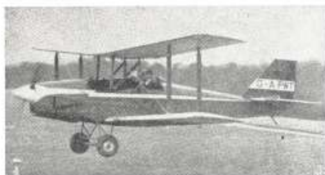
O u/l inglês Currie Wot servindo de banco de ensaio ao turbo-hélice TP 60
