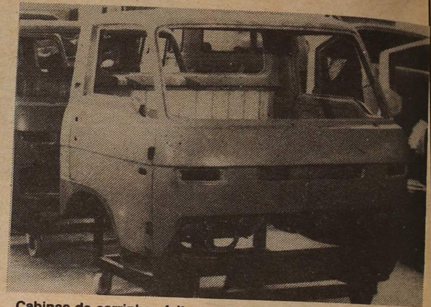
Cabins de carrinhas feitas em plástico reforçado com fibra de vidro
