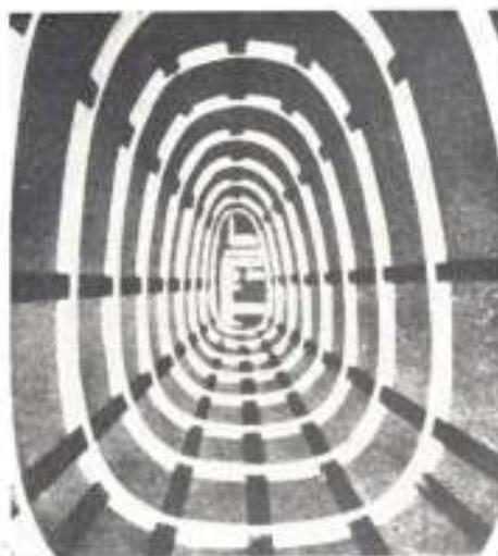
Fuselagem monocoque alum. caça Messerschmitt com cobertura de alumínio
