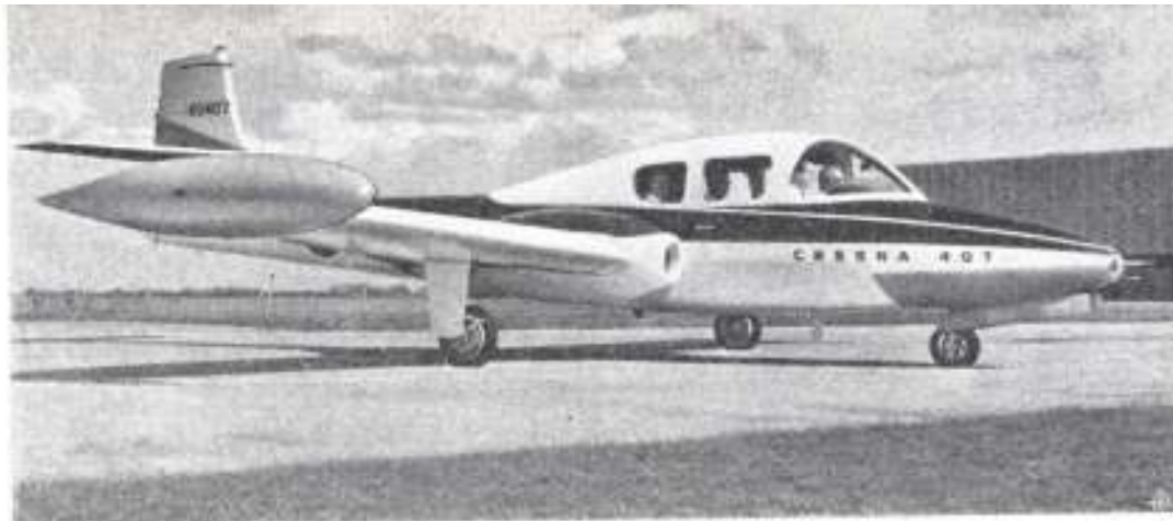
«CESSNA 407» — com 4 lugares equipado com dois turbo-reactores Continental 356-B (210 hp ) de 555 Kg. de peso, capaz de uma velocidade de cruzeiro entre 300 e 330 Km/h. Não é, evidentemente, o taxi aéreo do que falamos no artigo que se segue, mas trata as possibilidades inúmeras que oferece a aviação particular de aviação.
