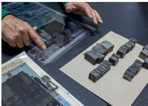
As antigas letras em chumbo e os fotolitos fizeram parte do processo de impressão no passado. Da máquina de escrever passou-se ao computador
