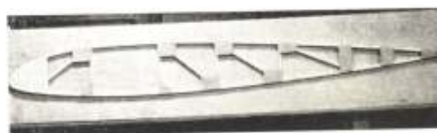
Uma nervura da asa do Bébé Jodel. Varelas de 7x10, contraplacado de 1,6 e 2,5, estaleiro, cola, serra, lixa, grampos... e goito.
